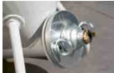
Регулируемое сопло (поз.1 - цемент; поз.2 - штукатурка)
